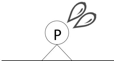
地上に設置の場合、ポンプトラブル時に高温水が飛散する可能性があります。
