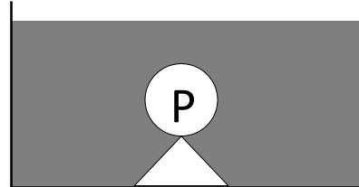
耐熱水中ポンプは水中に設置するので万が一の際も高温水は飛散しません。
