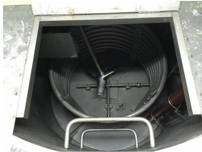
100°Cのホウ酸・リン酸アルミ含有水を冷まして水中ポンプで移送。
