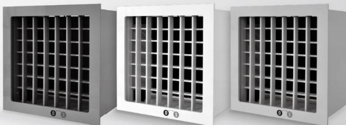
PVC(塩化ビニール)製のため、熱伝導率が低く、結露対策に効果的です。また、耐薬品性が高く、腐食の心配がありません。シャッター開閉角度が大きく、調整が容易に行なえます。基本色にグレー、ホワイト、アイボリーをご用意しています。
