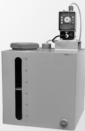
注入薬液を貯留・保存するタンクです。透明の目盛り付き窓から、薬液の残量を確認することができます。PVC(塩化ビニール)製のため、軽量なので運搬・施工が楽に手早く行なえ、耐蝕性・耐薬品性・耐水性・耐久性にも優れています。
