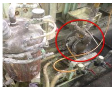
ADD型 ボンデ液(リン酸マンガン)の 循環ろ過
